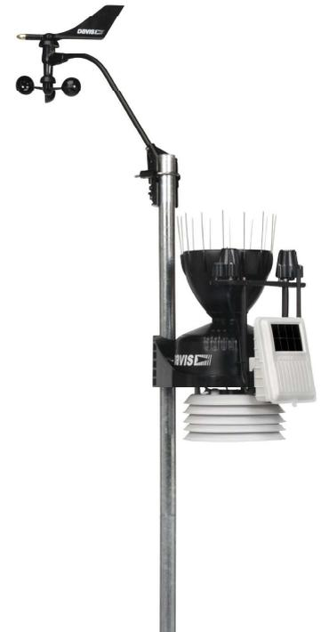
Für die Aufstellung der Messstation benötigen Sie etwa 1 Quadratmeter freie Fläche, die nicht für jedermann zugänglich sein sollte und max. 100 Meter von einem permanenten Internetanschluss (z.B. in Betriebsgebäude, Büro odgl.) entfernt sein sollte.
